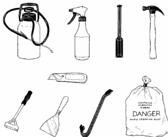
〈그림 1.6-3〉 고품 석면함유 바닥타일의 해체·제거용 장비
