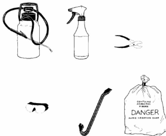
〈그림 1.6-6〉 고형석면함유 지붕재의 석면해체·제거용 장비
